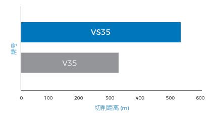
试验描述 - 断续车削 AISI 8620 线速度=200 m/min,切削深度=0.15 mm,进给=0.2 mm/rev
