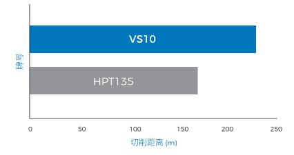
试验描述 - 断续车削 AISI 8620 线速度=200 m/min,切削深度=0.15 mm,进给=0.2 mm/rev
