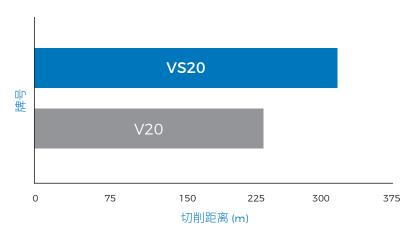
试验描述 - 断续车削 AISI 8620 线速度=200 m/min,切削深度=0.15 mm,进给=0.2 mm/rev
